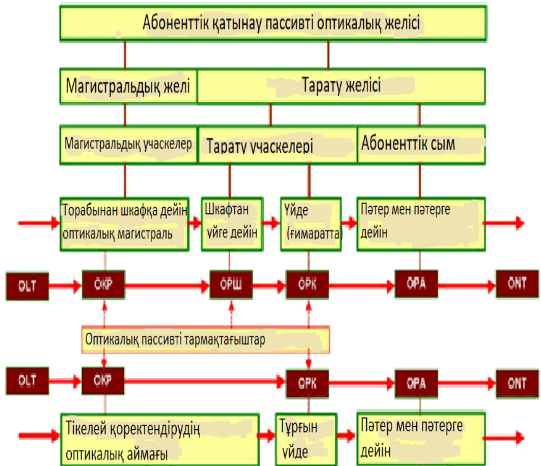
Сурет 1.2-желі құру топологиясының түрлері
